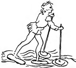
Abb. 148. Laufvorrichtung zum Überschreiten von Wasser, nach Leonardo da Vinci.
